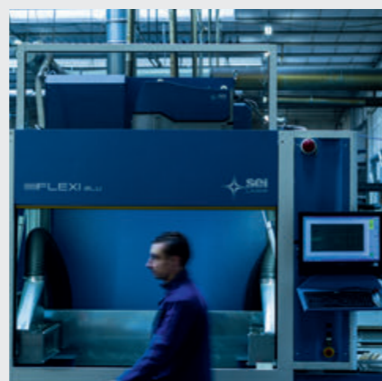
Machine pour la micro-gravure laser du PMMA Máquina de micrograbado láser de PMMA
