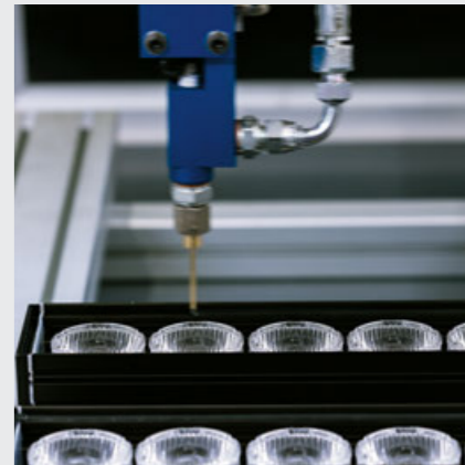
Siliconage du diffuseur.
