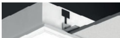
Détail de pose par le dessous
