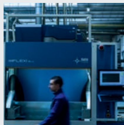
Machine pour la micro-gravure laser du PMMA.
