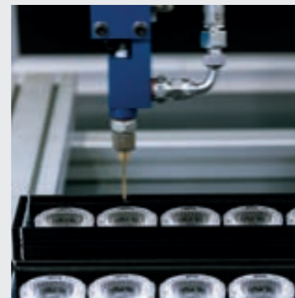
Siliconage du diffuseur.
